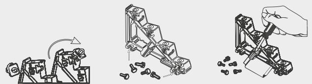
Eléments de fixation du capot présents dans les supports debarres.
